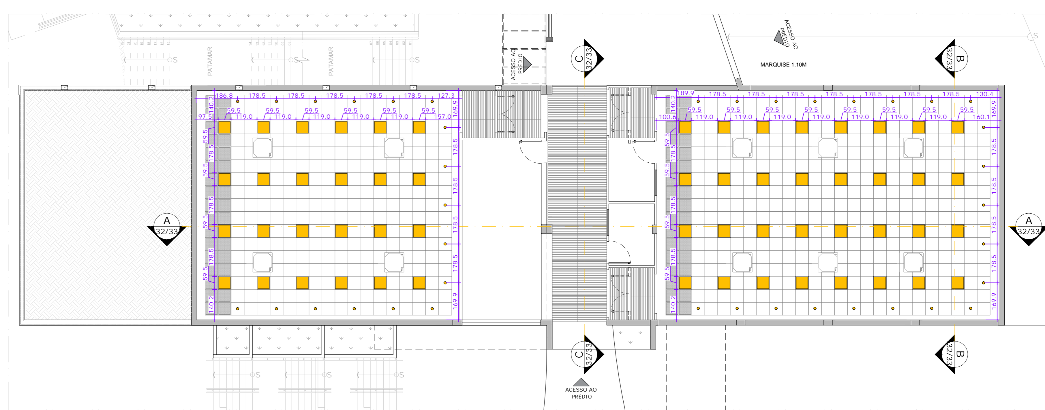
02 PLANTA LUMINOTÉCNICA AUDITÓRIO ESCALA 1:100
