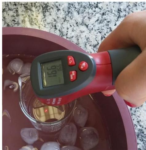
Conclusão: O béquer de 250 mL, forma alta, resistiu às condições normalmente utilizadas nos experimentos realizados no laboratório.
