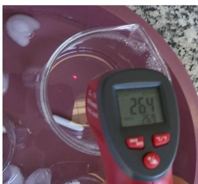
Conclusão: O béquer de 600 mL, forma alta, resistiu às condições normalmente utilizadas nos experimentos realizados no laboratório.
