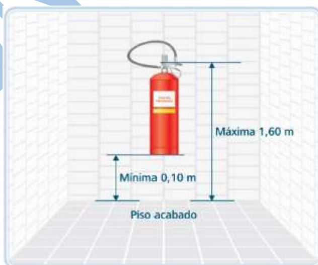
Figura 1: Altura para instalação de extintores.
