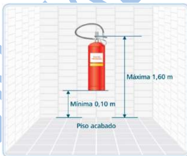
Figura 1: Altura para instalação de extintores.
