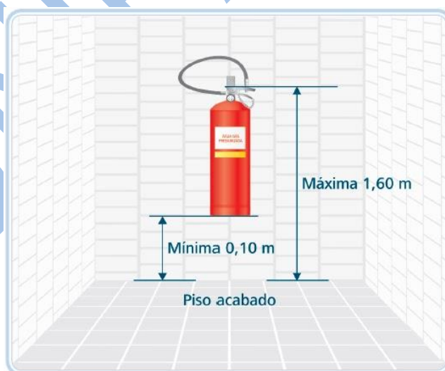
Figura 1: Altura para instalação de extintores.
