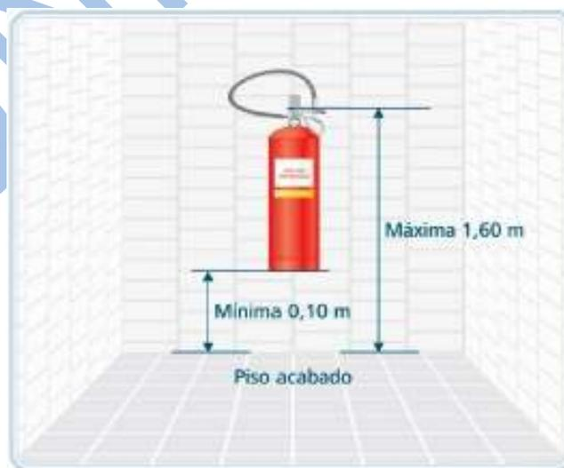
*Figura 1: Altura para instalação de extintores.*
